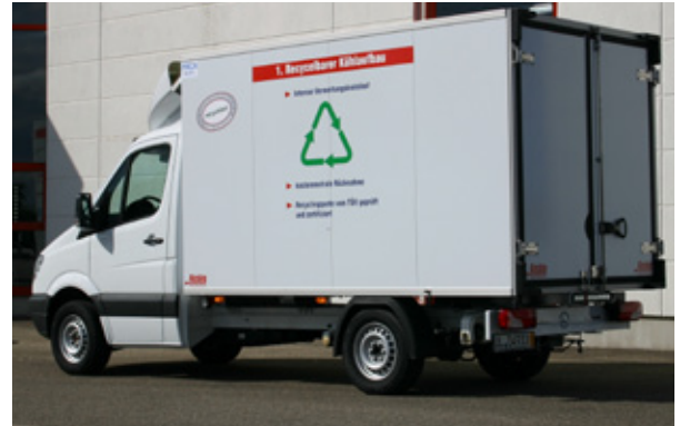
Fahrzeug mit dem deutschlandweit ersten, voll recyclebaren Kühllaufbau der Fa. Kiesling
