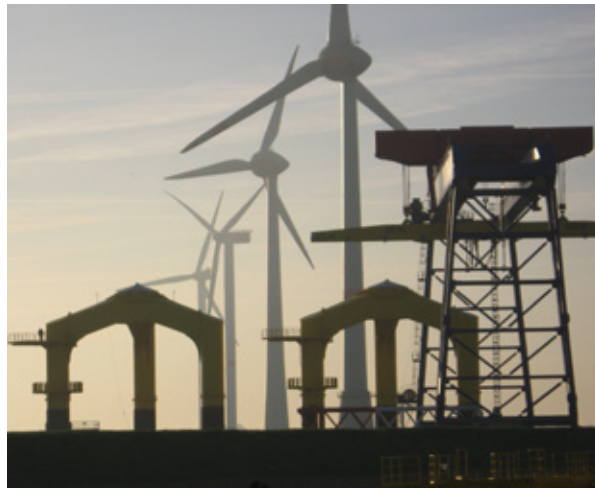
Die Produkte von CSC (Tripiles – Stahlgründungselemente) in der Morgensonne
