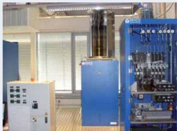
Anlage zur Abscheidung von Antireflexionsschichten
